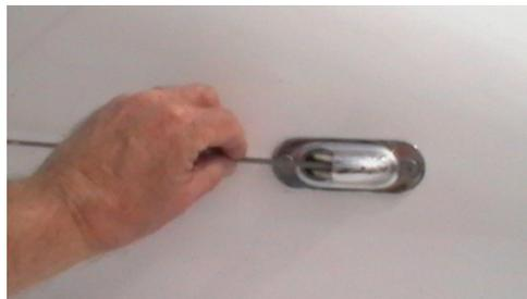
Réitérer l'ensemble de ses opérations sur le côté opposé du bateau. Vérifier pendant le changement d'orientation que rien (câble électriques ou tuyaux de carburant), ne risque d'entraver l'action de la direction.
